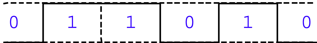
Figuur 2: Diepteprofiel van een spoor van een audio cd.
